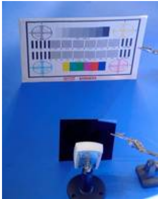
Testaufbau, Vor einer Kamera wird ein Infrorfilter gestellt
