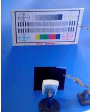
Testaufbau, Vor einer Kamera wird ein Infrorfilter gestellt
