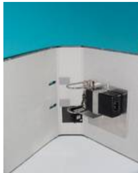
getarnte Überwachung durch Einbau einer Kamera in einen Aktenordner. Das "Fenster" ist hier ebenfalls mit dem Filter getarnt Hier könnte man z.B. den AXIS M7001 einbauen
