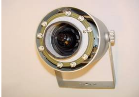
Offenes Gehäuse hier eine Spezialversion mit Infrarot I ED für den Nachtbetrieb
