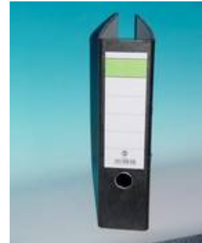
getarnte Überwachung durch Einbau einer Kamera in einen Aktenordner. Das "Fenster" ist hier ebenfalls mit dem Filter getarnt Hier könnte man z.B. den AXIS M7001 einbauen
